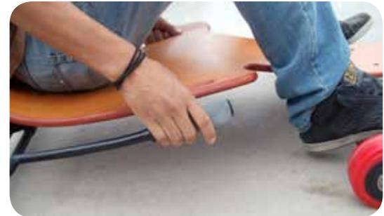
Figura 11. El freno del *skate* se acciona con la mano, mientras el usuario está en movimiento sentado sobre él.
