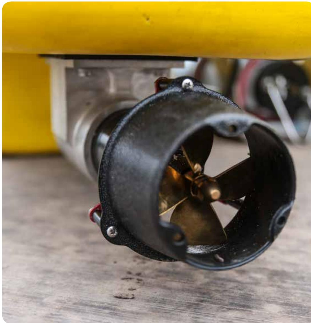
Figura 33. Hélice propulsora del robot acuático que le permite desplazarse en el agua.
