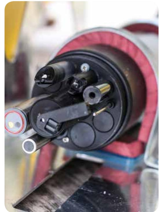
Figura 32. Sonda multiparamétrica utilizada para obtener parámetros físico-químicos del agua donde navega el robot.
