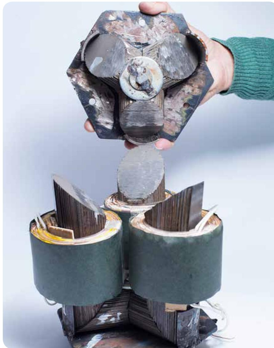
Figura 8. Vista frontal del núcleo del transformador trifásico modular.
