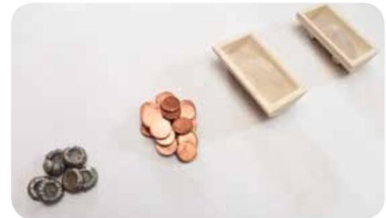
Figura 2. Materiales utilizados en la fundición: níquel, cobre, sílice en polvo y cal hidratada.
