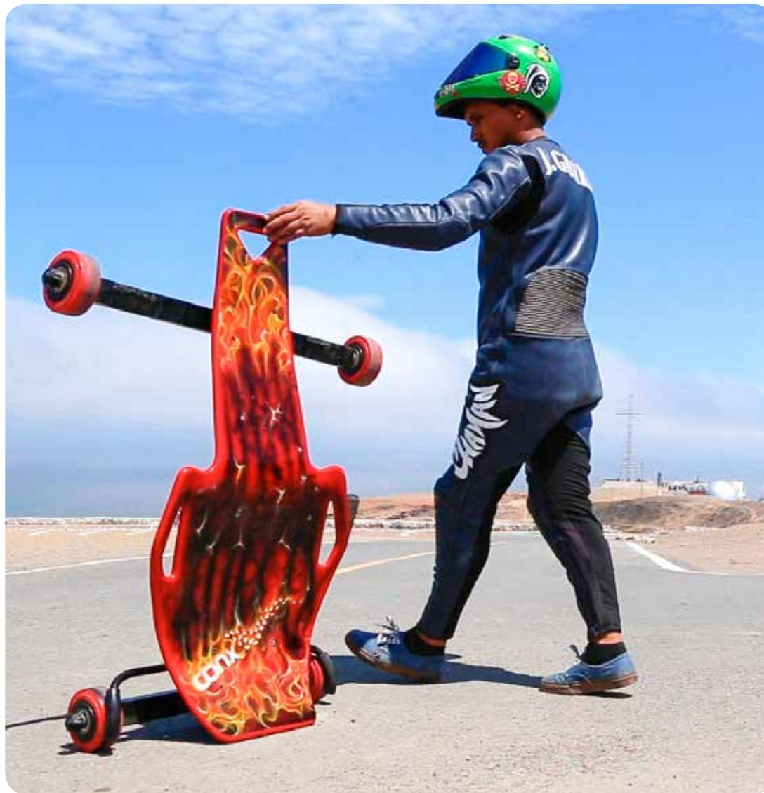
Figura 13. Agarradera superior del *skate* permite sujetarlo desde uno de sus extremos para transportarlo fácilmente.
