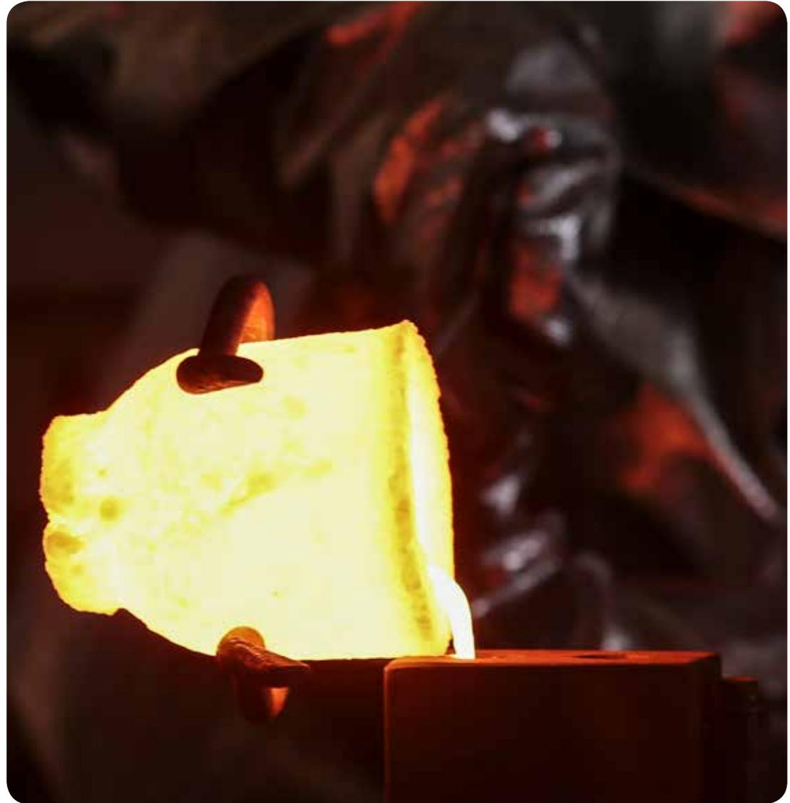
Figura 4. Vertido de la aleación fundida en un molde de arcilla.
