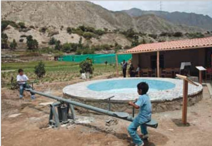
**Bomba sube y baja.** Extrae agua de las cañerías por medio de pistones.
